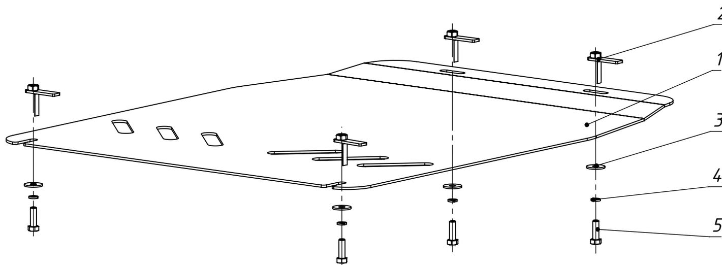
1. Установить закладные планки (поз. 2 ) в штатные отверстия продольных балок двигателя и поперечной балки кпп.
