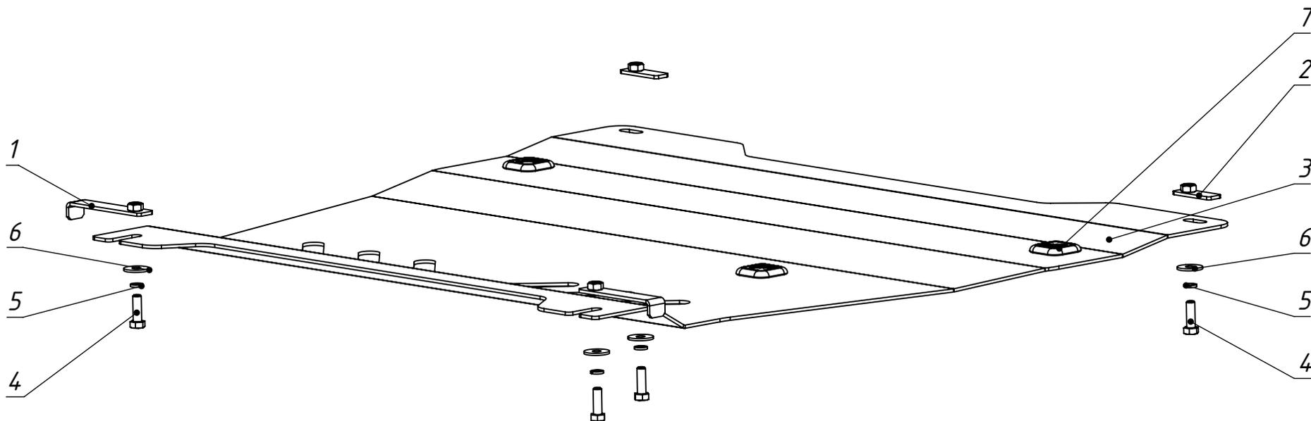
1. Установить закладные планки (поз. 1 ) в штатные отверстия поперечной балки.
