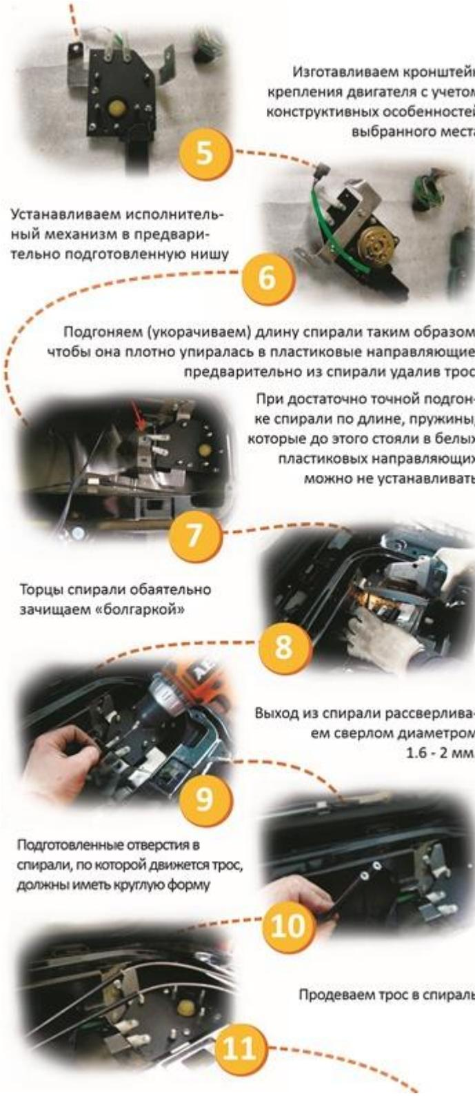
Одеваем металлические наконечники. Подготовленную спираль с одетыми колпачками и продетым тросиком монтируем в пластиковое направляющее
